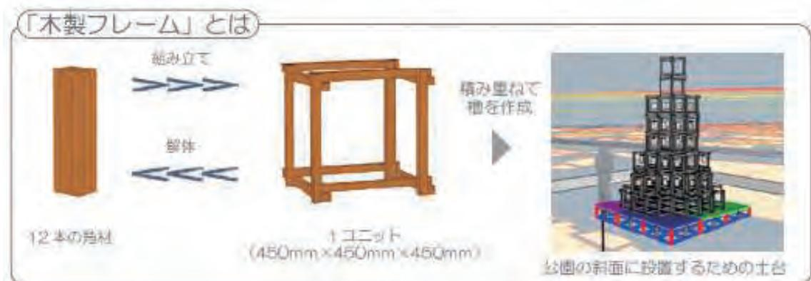
図1 木製フレームと櫓のモデリング
