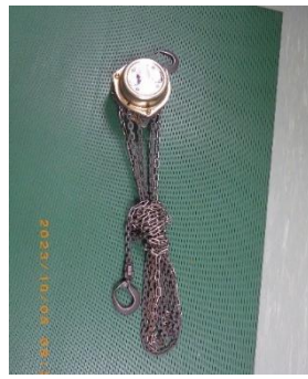
図 19 巻き付けたスプリングワイヤー 及びチェンブロック
