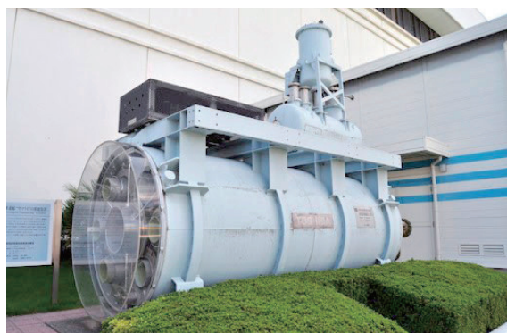
写真 1 推進装置ユニット(超電導磁石+ヘリウム冷凍機)の外観
