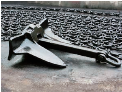
練習船深江丸のKS-8型錨：空中重量 965kg・標準把駐係数 7.2（泥） KS= 神戸商船大学（で開発）
