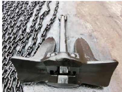
練習船深江丸のKS-8型錨：空中重量 965kg・標準把駐係数 7.2（泥） KS= 神戸商船大学（で開発）
