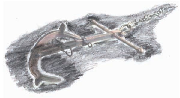
ストックアンカーが海底を掻くイメージ
