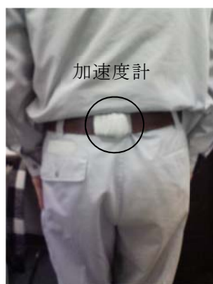
図1 3軸小型加速度計装着の概要
