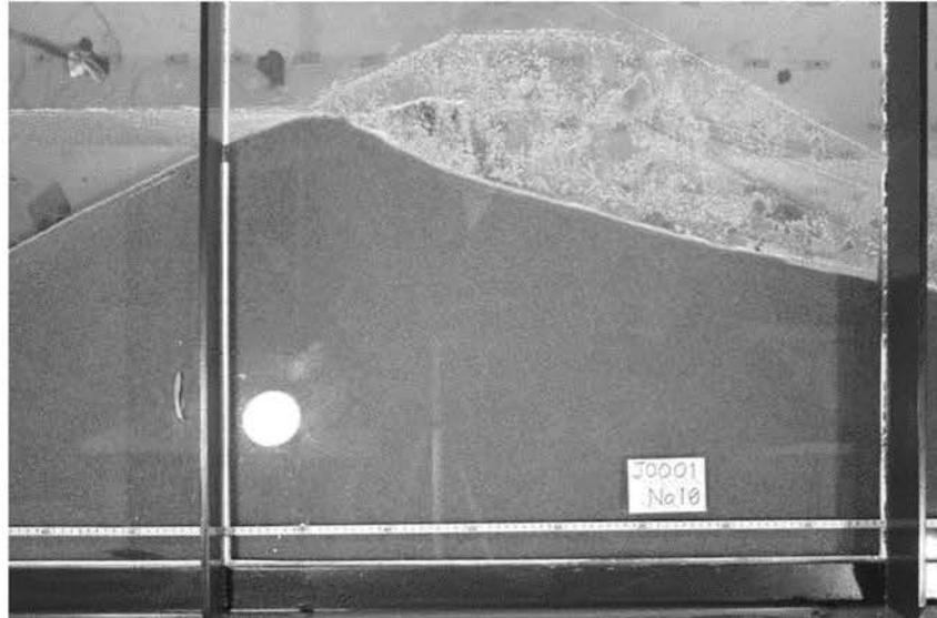
Fig.10 実際の地盤の表面形状(実験開始後 17 時間 10 分後)(破壊直前)
