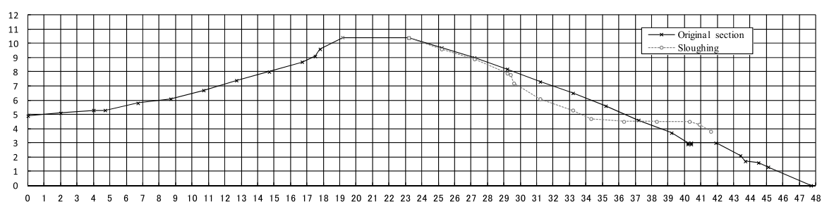
Fig.34 高山池の横断面形状と法くずれ部分の形状
