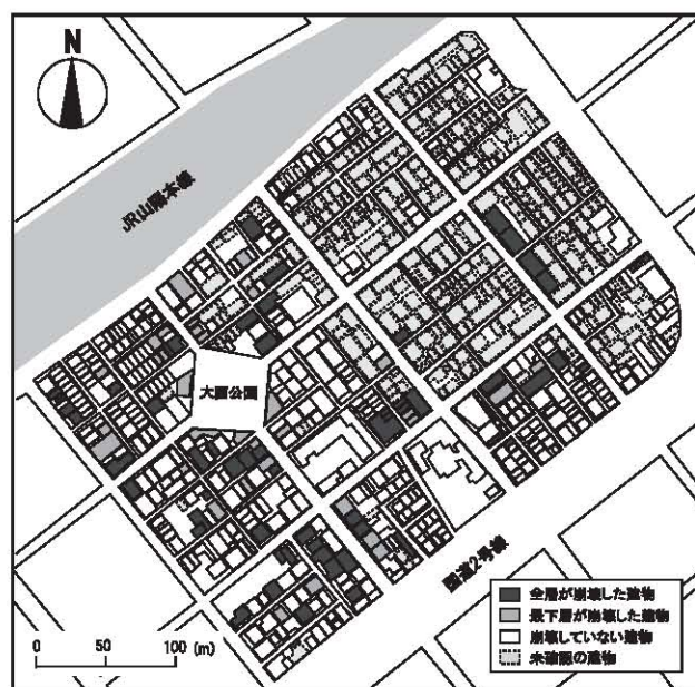
図 9 高橋病院周辺での建物の損壊状況
