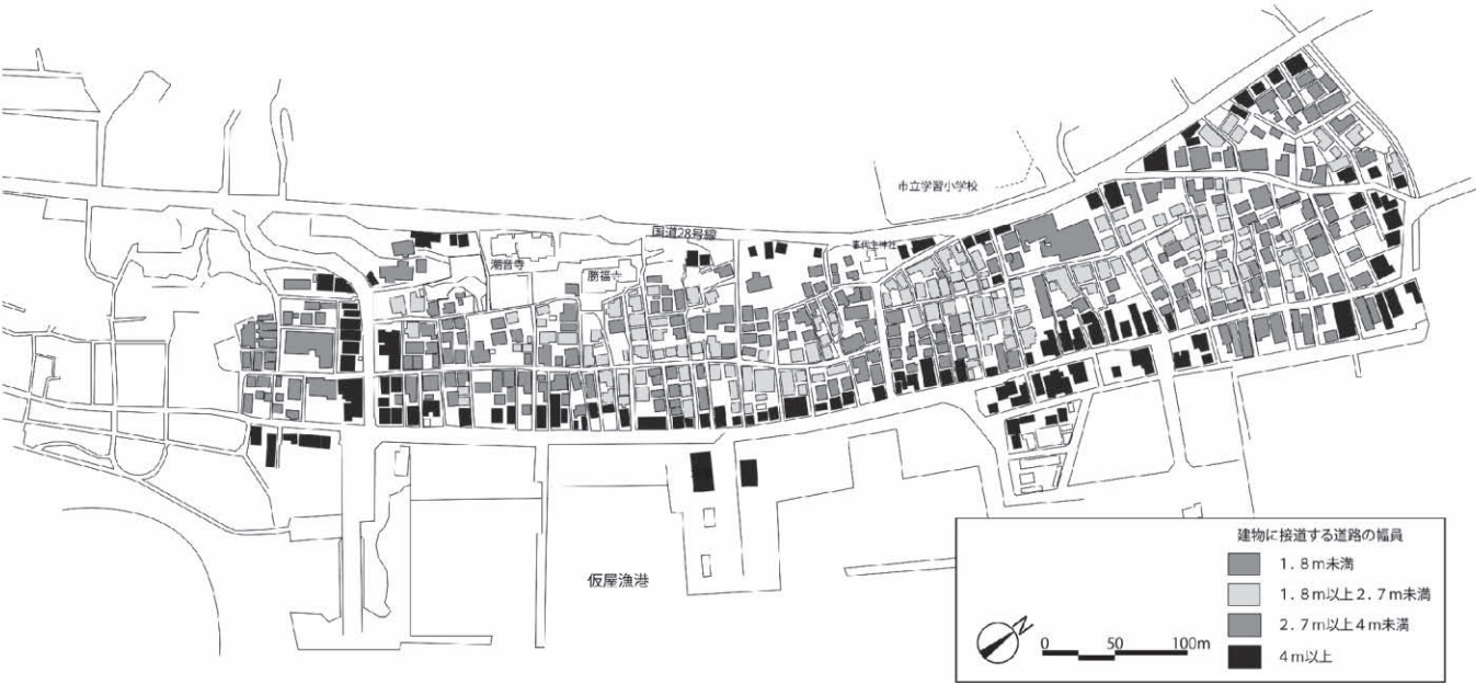
図 11 仮屋地区の震災前の接道状況
