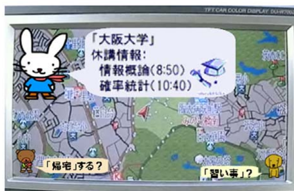
図2 目的予測型カーナビゲーションシステムの表示例
