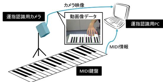
図 2 運指認識システムの構成
