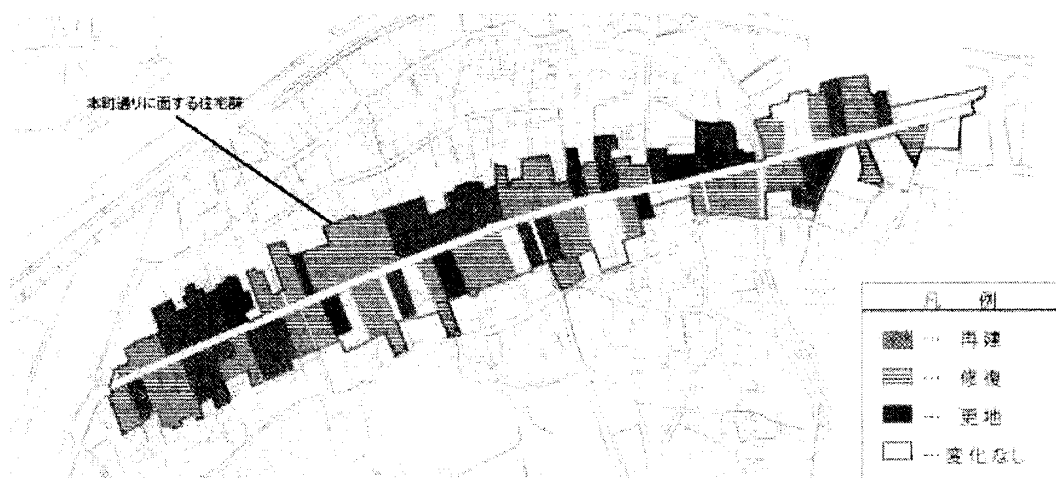
図1. 本町通り沿いの復興状況 (H22.10時点の現地踏査による)
