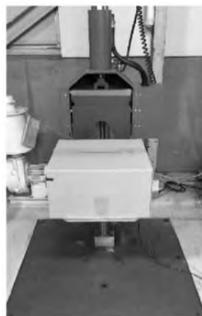
Fig.11 Free fall test
