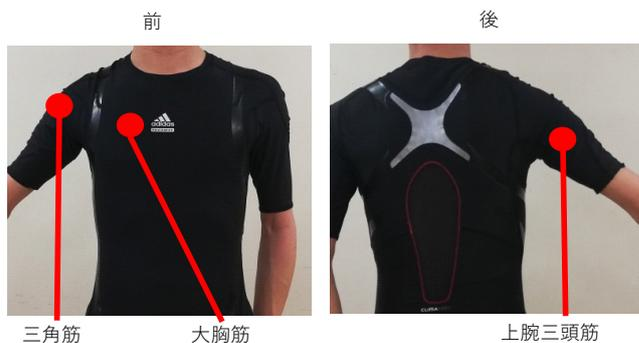
図 2: 筋電位計測箇所
