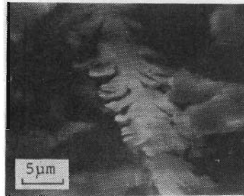
図 3-23 ジルコニアセラミックスの超精密高速切削における切りくずのSEM観察例
