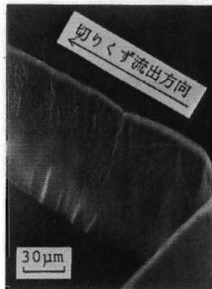
図 3-9 無酸素銅の超精密高速切削における切りくずのSEM観察例
