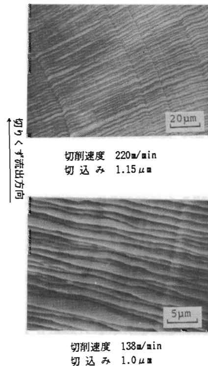
図 3-18 S25C及びS45Cの超精密高速切削における切りくずのSEM観察例 (その2)
