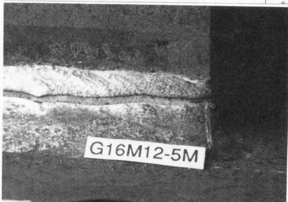
a) 梁フランジ溶接部の破断
