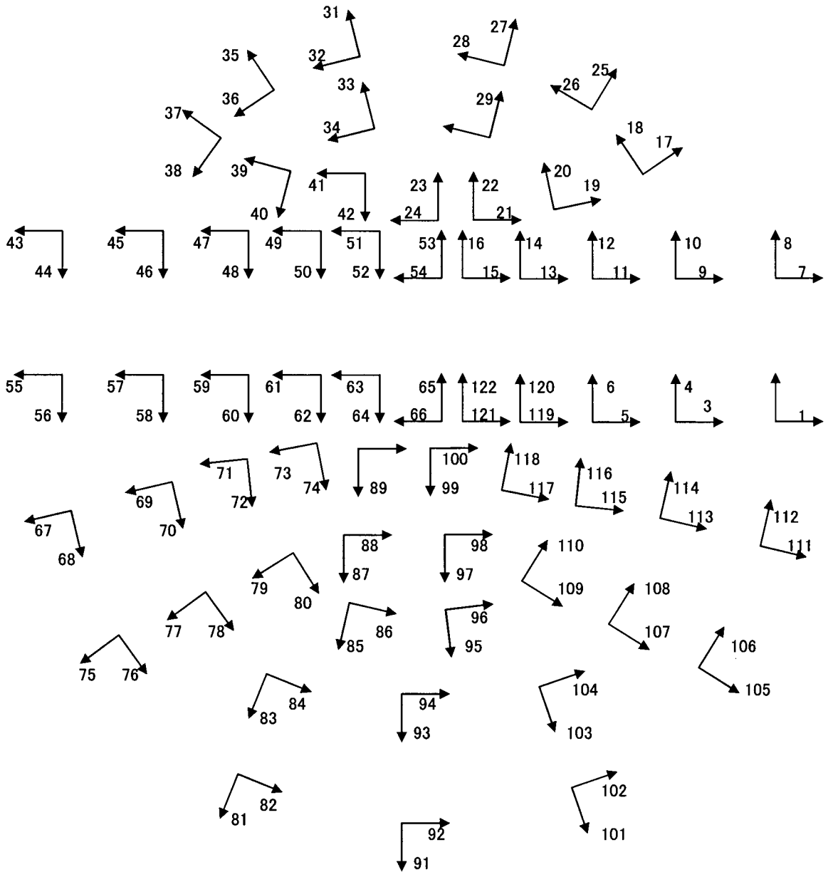
図 1 122ch 全頭型脳磁計のセンサー配置 (NeuroMag-122, Finland)
