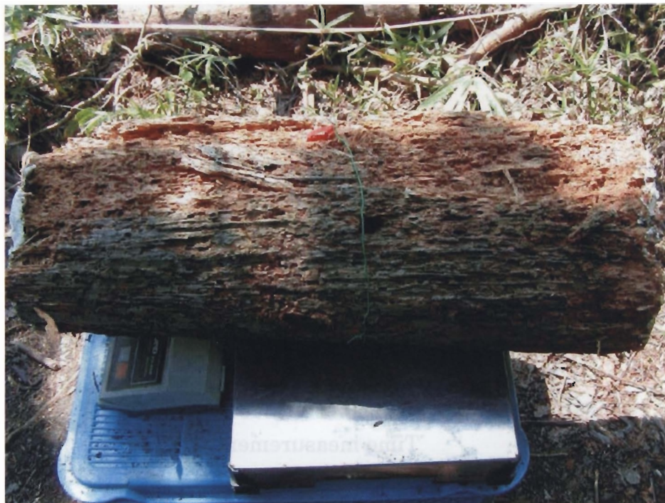
図4-3. (a) フィールドでの枯死木呼吸の測定.大チャンバーを用いている. (b) 枯死木の生重の測定. (a) Field measurement of CWD respiration using a large chamber. (b) Measurement of fresh weight of CWD.
