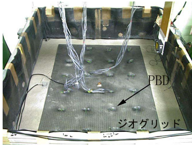
写真 2.3 地盤作製後の状況 (排水 PBD6×4(A-1))
