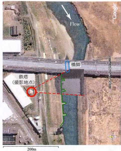
図 9.5: 宇治川水制周りの撮影アングル (鉄塔から第一と第二水制間を中心に撮影)
