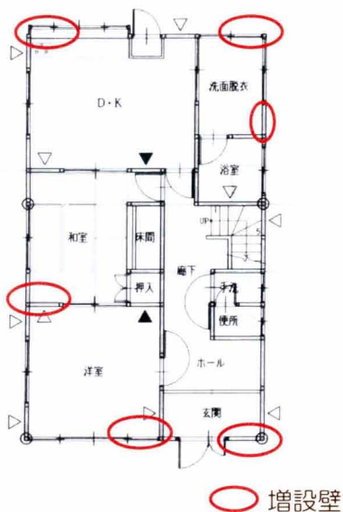
図-5.31 ISH の補強箇所（増設壁位置）
