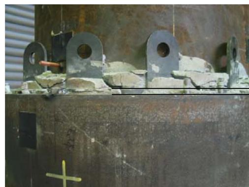
写真 3-7 解体用プレートの抜け出し: RRP-S2
