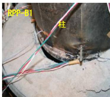
写真 5-5 柱とコンクリートの離間
