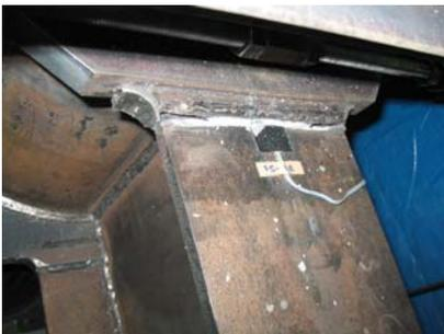
写真 3-1 梁端の破断：HRP-1
