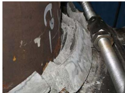
写真 3-2 モルタルの圧壊：HRP-3
