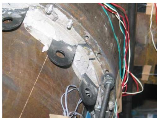
写真 3-5 かぶりモルタルの破壊: RRP-S2
