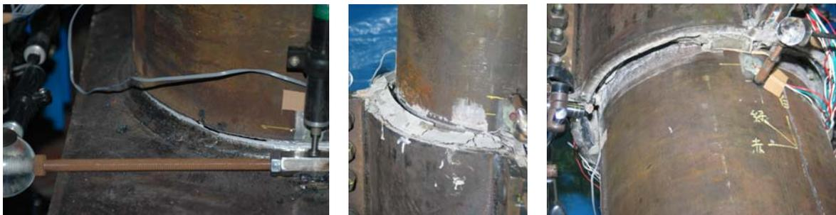
(a) 柱脚の破断 : CJ-EP1      (b) 接合用鋼管上側 : CJ-EP4      (c) 接合用鋼管下側 : CJ-EP4
