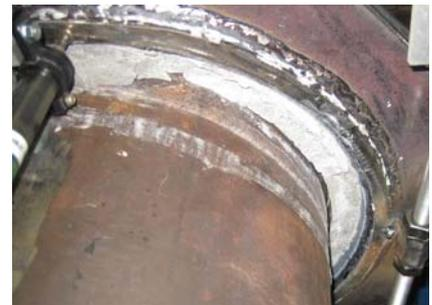
写真 3-3 モルタルの圧壊：HRP-3
