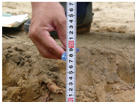
写真 5-16 限界高さ H_c の測定
