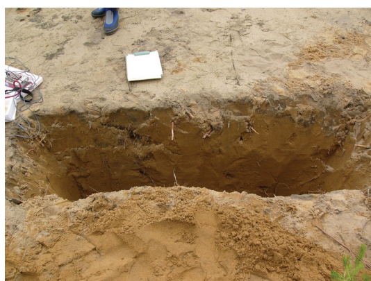
写真 5-13 崩壊前のテストピットの状況
