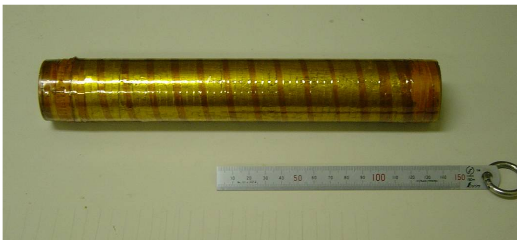
図 7-4 ダンパーコイルの完成写真
