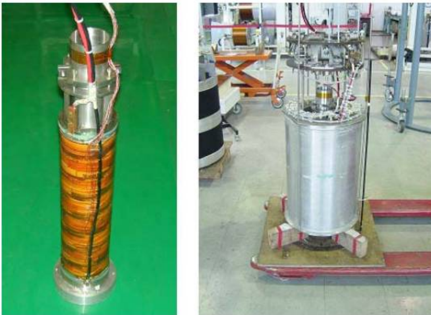
図 8-1 コイル No.1 の外観写真と外部磁場コイルに組み込んだ状況
