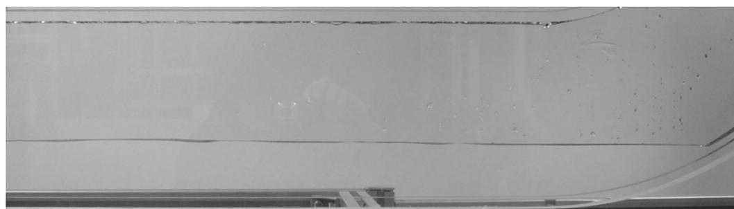
図 6.5 層状流(グリセリン水溶液 60 wt%,  $J_G = 4.3$  m/s,  $J_{Lin} = 0.06$  m/s)
