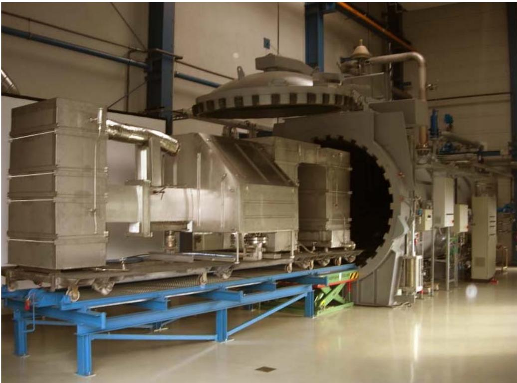
(b)  $\phi 2.5 \text{ m} \times 7 \text{ m}$  の圧力容器 TOPFLOW
