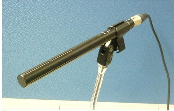
図 3.10 Shotgun microphone (SONY ECM-674)
