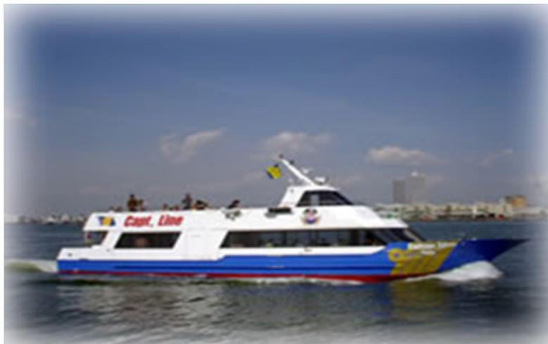
D 船 JG 船舶・客船（総トン数 100 トン、出力 600 馬力、速力 11 ノット、定員 160 名）
