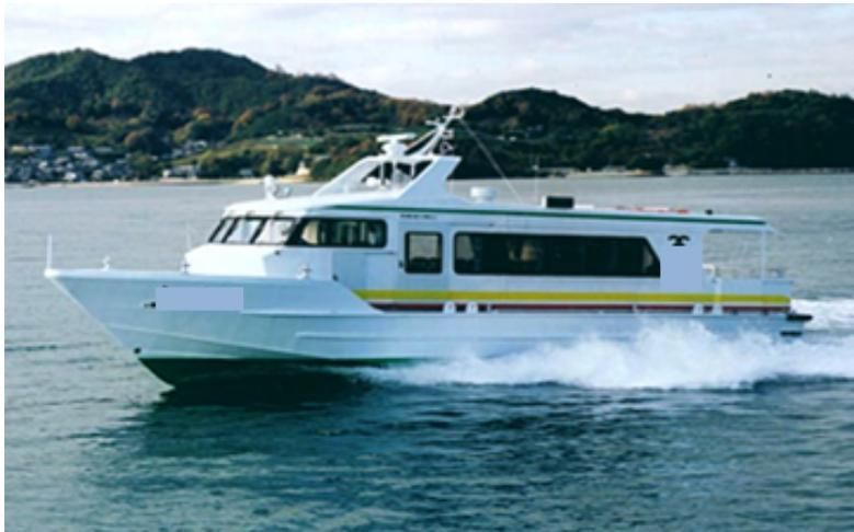
C 船 JCI 船舶・客船（総トン数 19 トン、出力 300 馬力、速力 11 ノット、定員 80 名）
