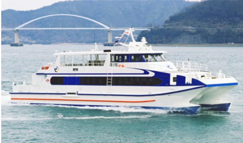
B 船 JG 船舶・高速船（総トン数 100 トン、出力 2400 馬力、速力 22 ノット、定員 160 名）
