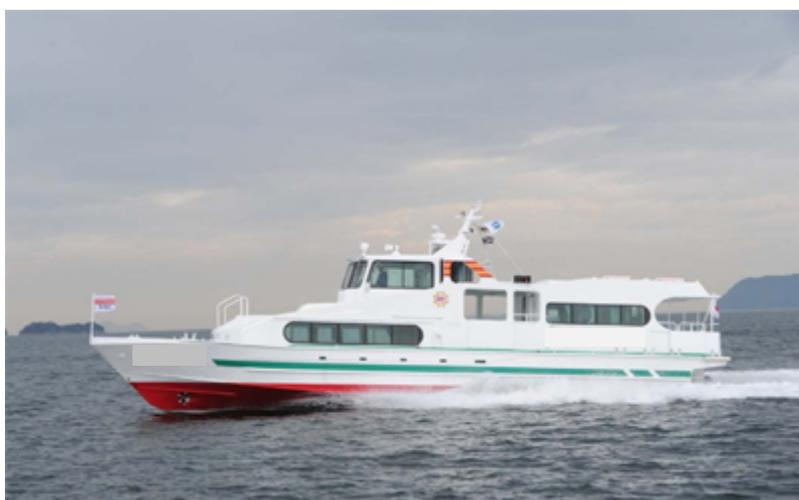
A 船 JCI 船舶・高速船（総トン数 19 トン、出力 1200 馬力、速力 22 ノット、定員 80 名）
