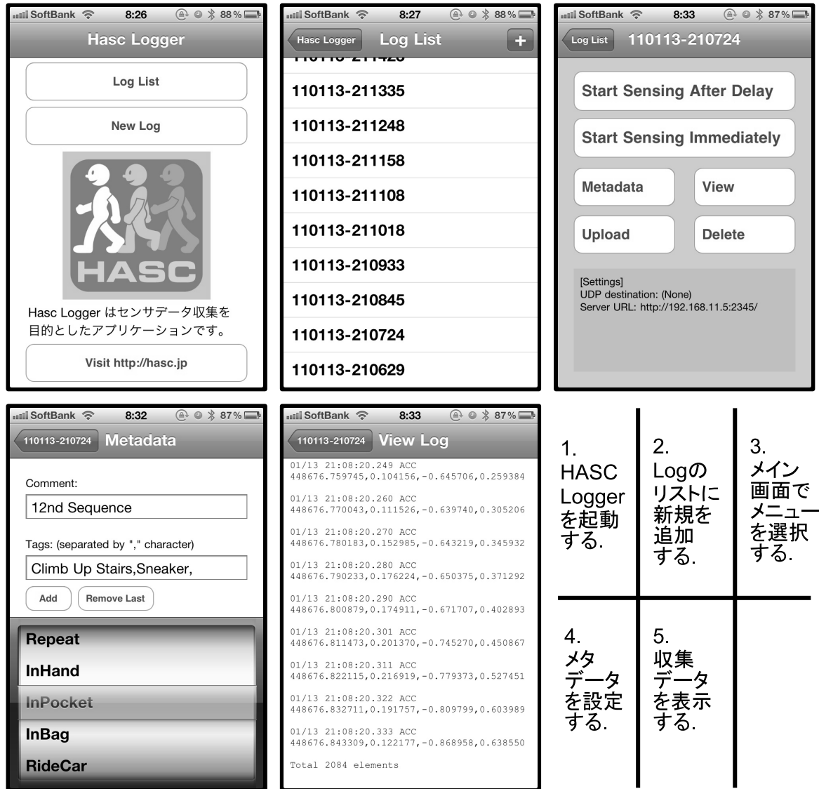
図 5.2 HASC Logger を用いた加速度データ収集
