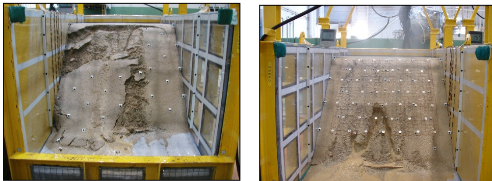
図 6.4 無対策と対策斜面の崩壊状況
