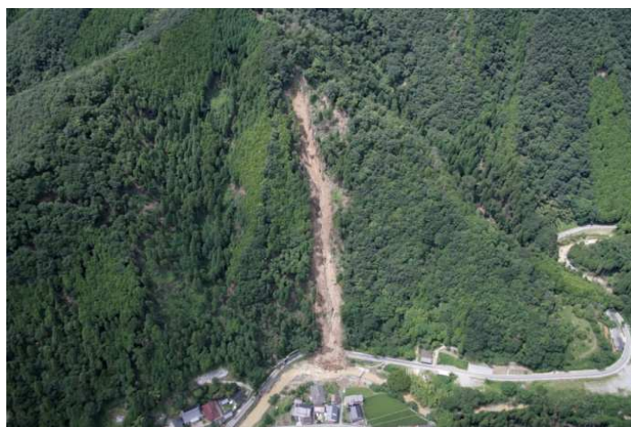
図3.3 2009年台風9号による山腹斜面崩壊の事例（兵庫県佐用郡佐用町上石井：国際航業株式会社撮影）
