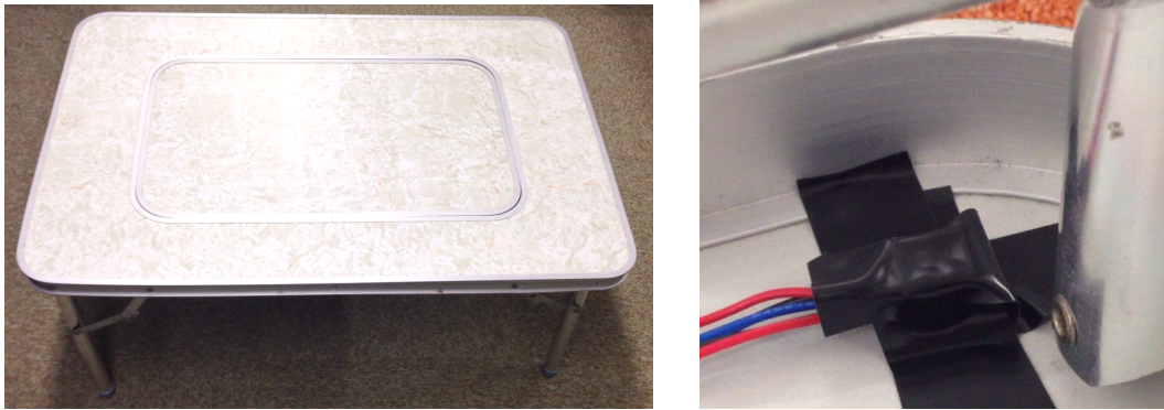
図 44: テーブルに加速度センサを貼り付ける
