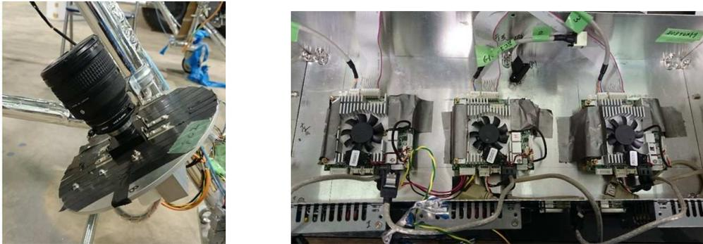
図 5.9: ゴンドラへのスターカメラの取り付けと CPU ボード : (左) ゴンドラに取り付けたスターカメラ。(右) アルミケースに取り付けたスターカメラ用 CPU ボード
