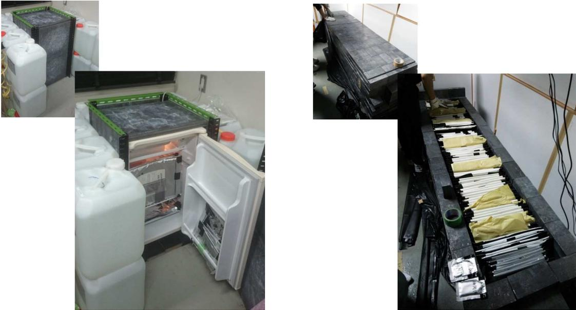
図 3.31: (左) 神戸大学発達科学部 G104 に設置した遮蔽環境。(右) 神岡鉱山の遮蔽環境。岐阜大学仲澤研究室が設置した鉛箱のスペースを一部借りてフィルムを保管した。
