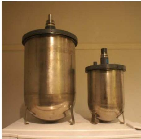
図 2.5: (上左) 量産用乳剤製造装置。(上右) R&D 用乳剤製造装置。(下) 乳剤製造に用いられるステンレスタンク。左のタンクが量産用 (3L)、右が R&D 用 (1L) である。
