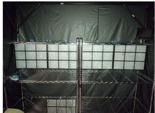
図 3.39: (左) 実験前処理用の暗室テント (2.8 m(W)×1.9 m(D)×2.0 m(H)) , (右) リセット処理用のメタルラックにフィルター枠を吊るした様子
