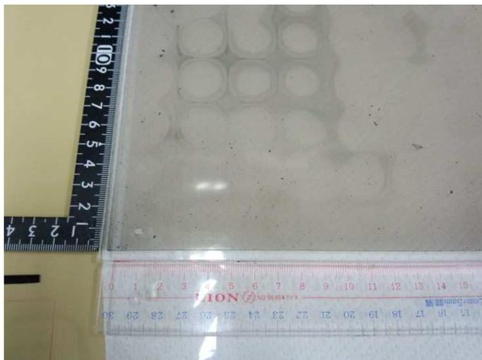
図 5.22: 乾燥用支持板に開けた穴に対応するパターンが見られる黒化エラーフィルム
