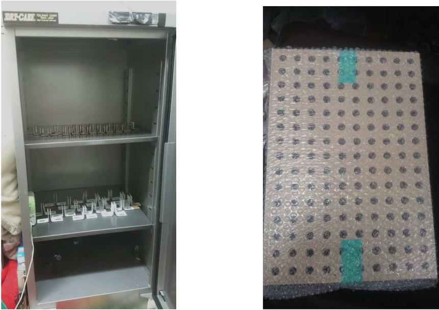
図 3.18: (左) 選定したドライキャビ (右) 乾燥用支持板
