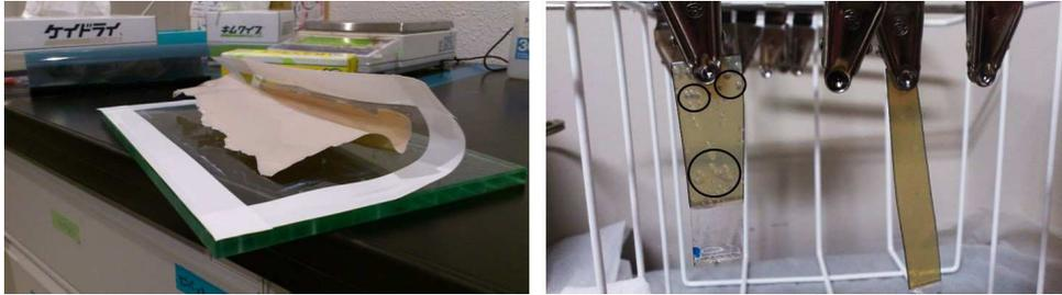
図 3.23: 塗れ性に関する R&D 期に起きたトラブル。(左) ベースから乳剤が剥がれている様子。(右) 丸で囲った領域などに水ぶくれが発生したフィルムとファイナルドライをして水ぶくれのないフィルム
