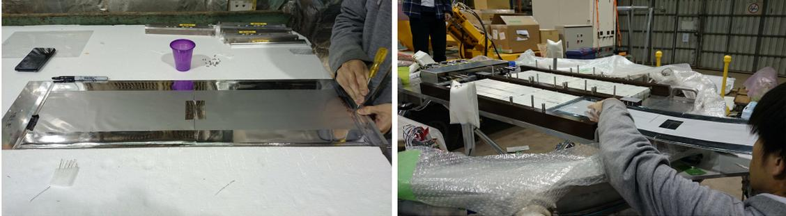
図 D.1: 2015 年豪州気球実験における多段シフターのステージへのフィルム貼りつけ及びマウント風景：(左) ステージに貼りつけたタイムスタンプフィルム。(右) 多段シフターにステージを挿入している様子
