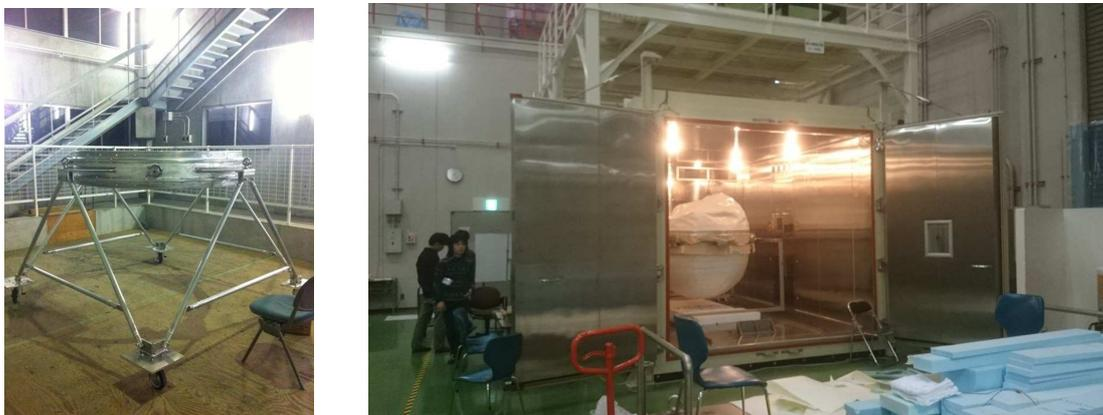
図 5.4: (左) 2015 年豪州気球実験で用いるゴンドラ (@名大高圧実験棟) (右) JAXA 恒温試験槽における与圧容器の低温試験
