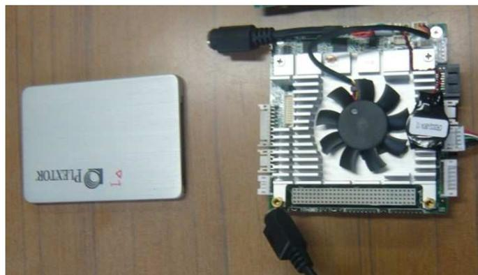
図 4.3: 選定したスターカメラ CPU ボードと SSD
