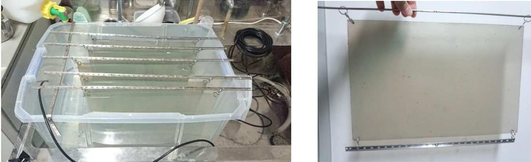
図 6.2: (左) グリセリン膨潤のためにフィルムを水浸処理している様子 (右) 膨潤後のエマルジョンフィルム
