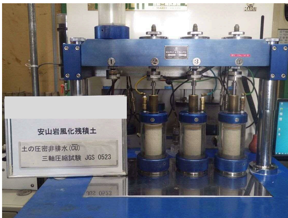
写真 4.5 CUB 試験状況・試料 No.1
