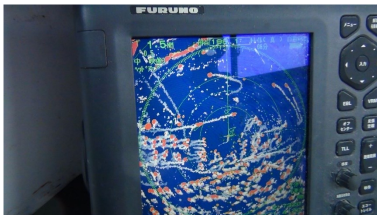
Fig. 4-2 AIS 情報とレーダとの重畳表示
