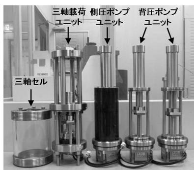
図-4.2 三軸荷重装置
