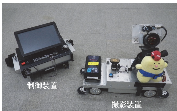
写真 6.2 撮影装置と制御装置 (愛称：本四まもるくん(仮称))
