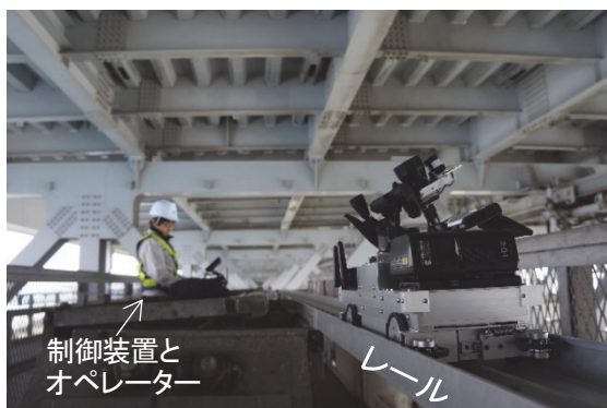
写真 6.1 開発装置による撮影状況
