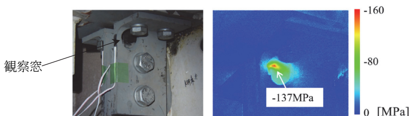
(b) 当て板補修後（亀裂存置）の状況と応力分布
