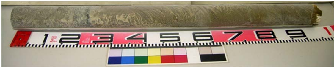
図3-31 採取した不攪乱試料試料の全景
