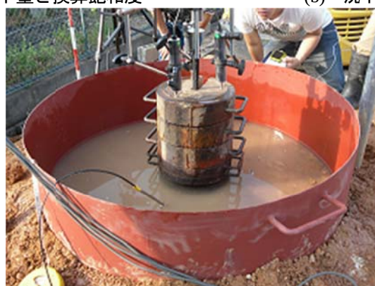
(c) 締固め盛土の水浸沈下の様子
