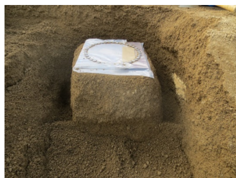
(b) 試料の粗削り
