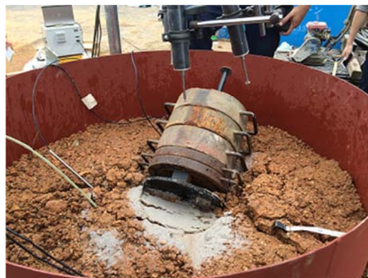
(b) 地盤崩壊の様子
