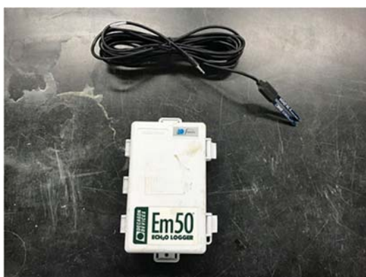
図5-6 土壌水分計(Ec-5)およびデータロガー(Em50)
