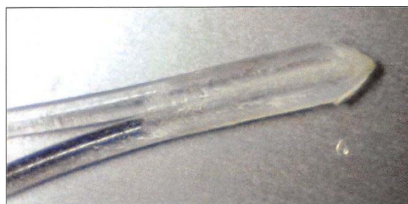
図D-5 光ファイバーの様子(直径1mm) 2)
