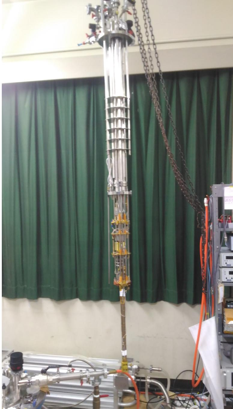
图 31:  $^3\text{He}$ - $^4\text{He}$  混合希积冷冻机
