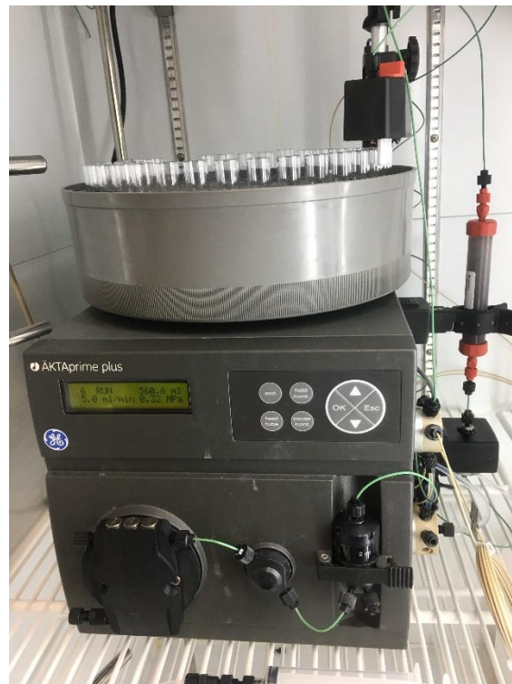
図 A2-11 ACTA を用いてコンピューターにより gradient 溶出させている様子。
