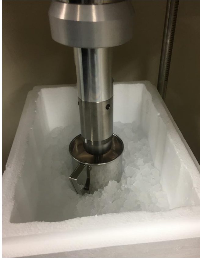
図 A2-8 大腸菌を破碎中している様子。
