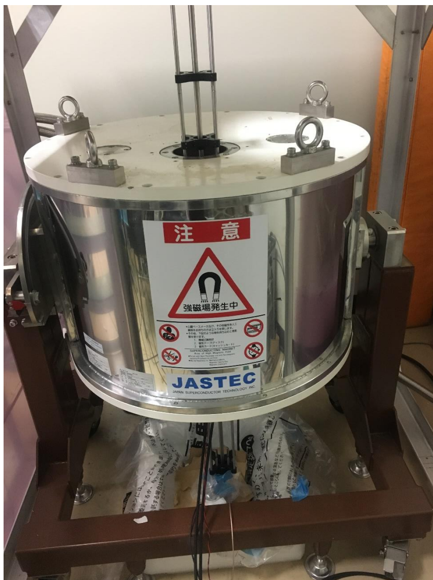
图 3-6 无冷媒型 10 T 超传导磁石。
