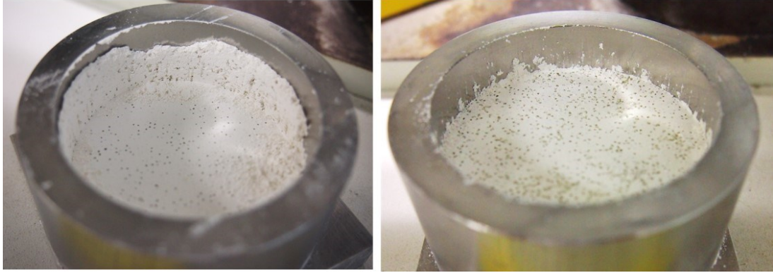
図 2.6 容器内壁に残ったサンプル. 実験 3 で用いた試料. 写真は明るさ・コントラストを調整してある. (左)容器内径 \phi 60 mm に対し \phi 55.4 mm のピストンを用いた場合. 容器内壁にサンプル粒子が残る. 試料はダスト粒子が Silica powder ( 1.5 \mu\text{m} ) で, ダスト体積含有率が 0.38 のもの. (右)容器内径 \phi 58.8 mm に対し \phi 58 mm のピストンを用いた場合. 容器内壁にサンプル粒子はほぼ残らない. 試料はダスト粒子が Silica powder ( 1.5 \mu\text{m} ) で, ダスト体積含有率が 0.22 のもの.
