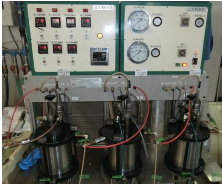
写真 5.21 加圧透水試験機の外観
