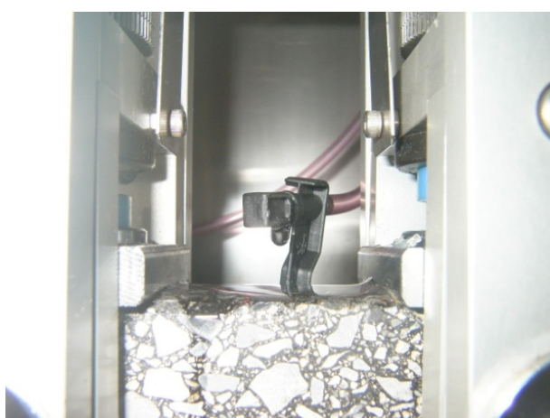
写真 4.7 試験供試体表面の水膜の状況
