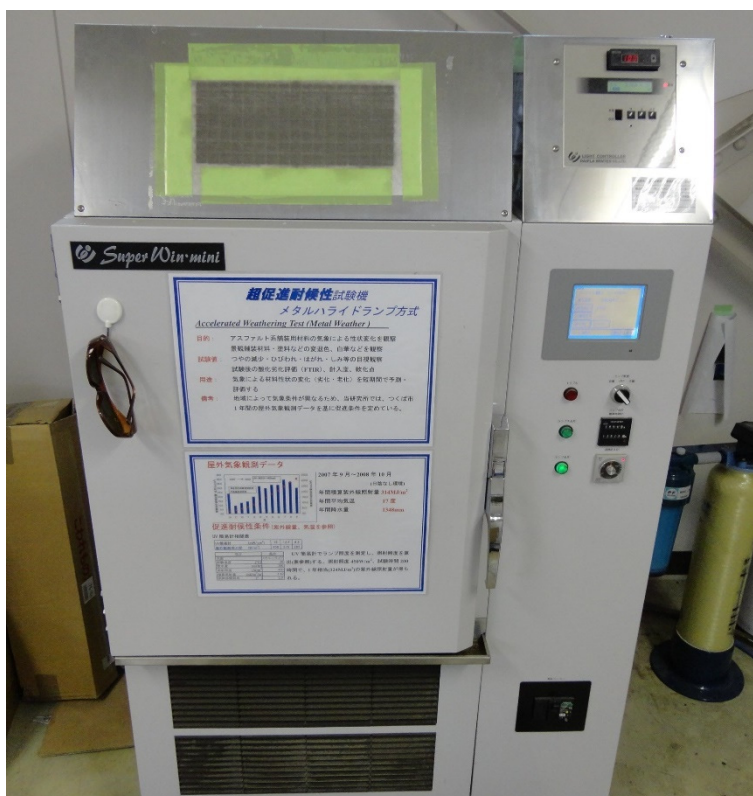
写真 3.13 耐候性試験機の外観
