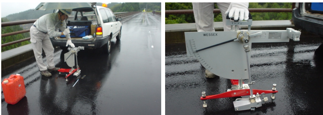
写真 6.5 すべり抵抗性試験測定状況
