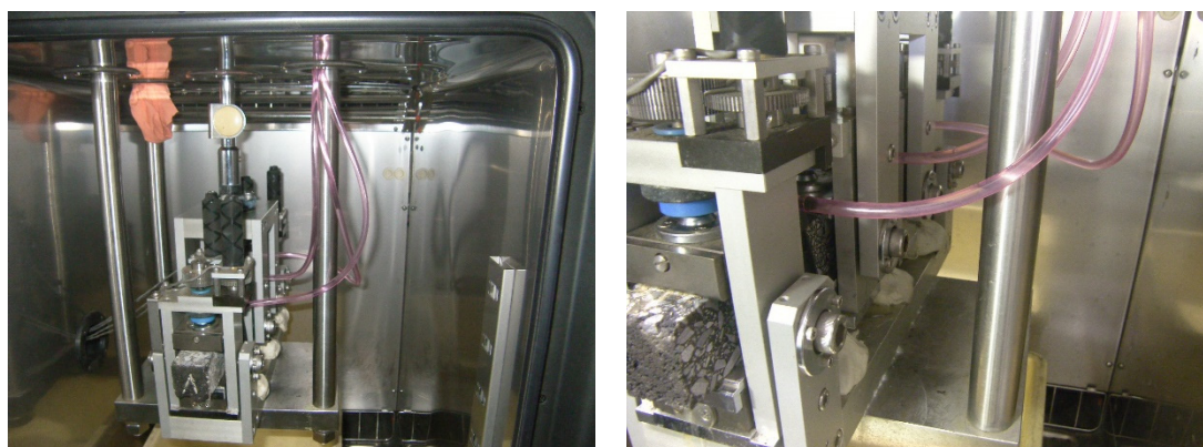
写真 4.5 点滴装置による散水状況
