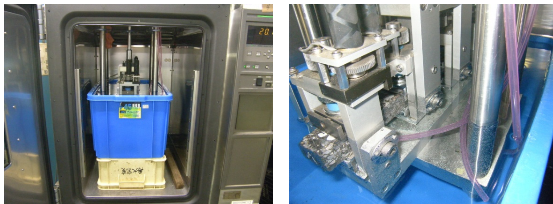
写真 4.4 全水浸法の試験状況
