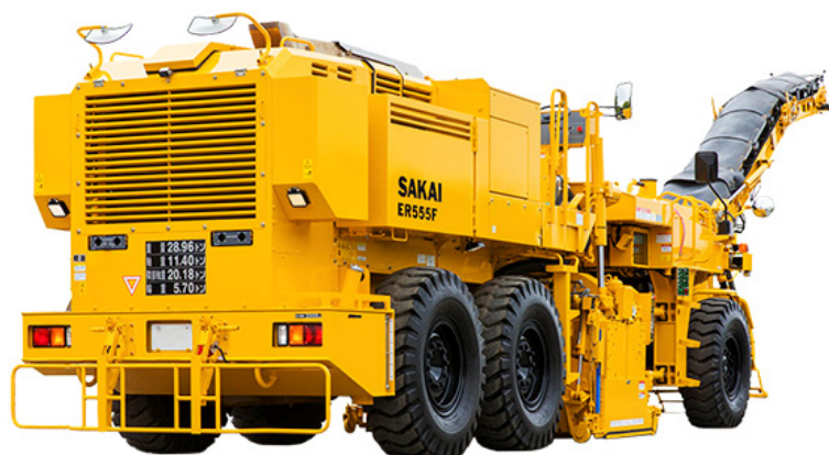
写真 3.4 切削工法に用いられる切削機 3)
