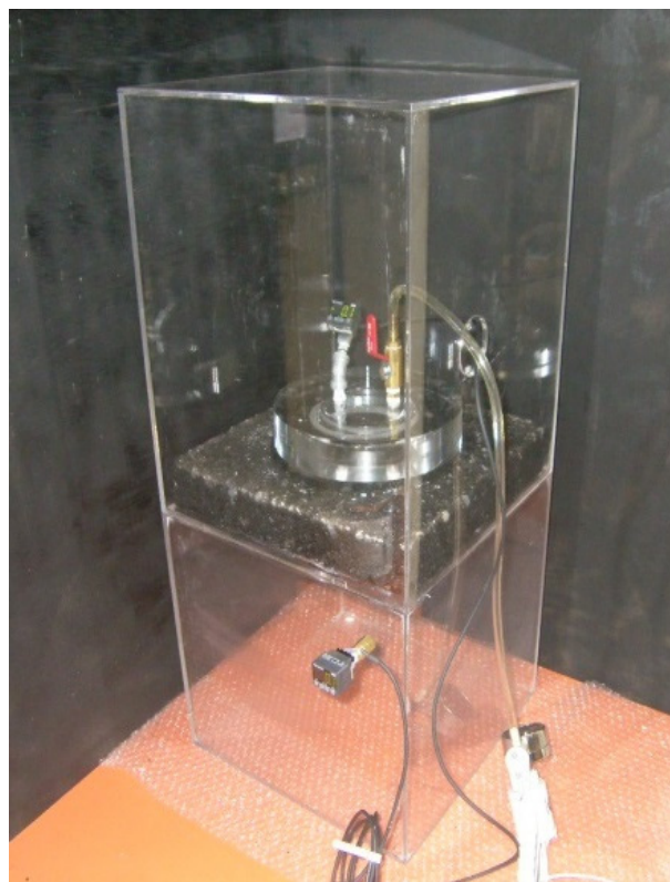
写真 5.9 密閉容器に設置した現場透気試験器の状況
