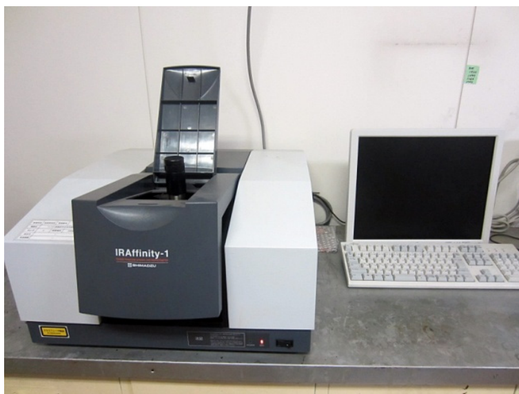
写真 3.16 フーリエ変換赤外分光分析装置の外観
