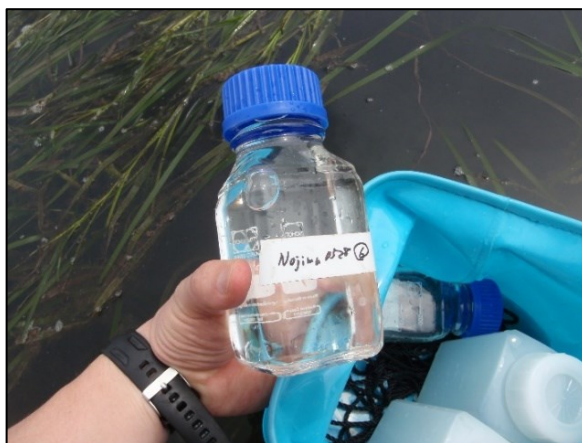
写真 2-2-2 TA・DIC測定用サンプルの採取の様子
