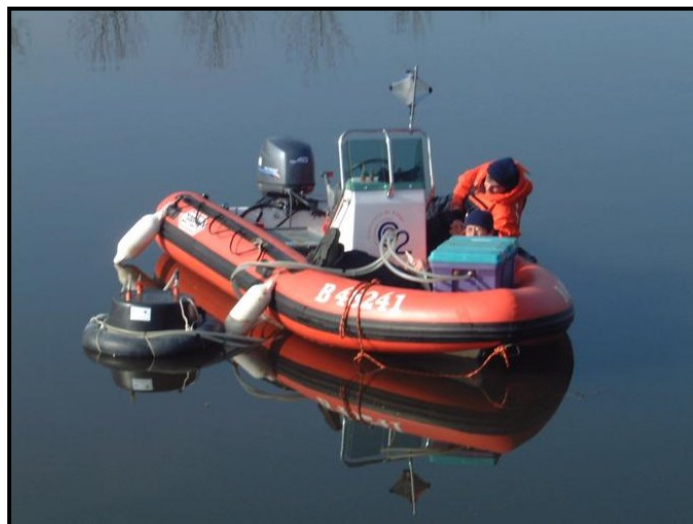
写真 2-2-5 フローティングチャンバー法による計測状況
