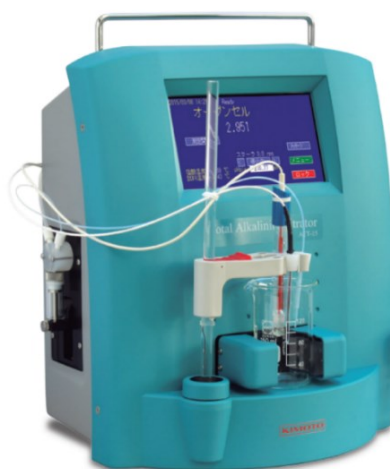
写真 2-2-3 TA・DIC分析装置（ATT-15，紀本電子社製）
