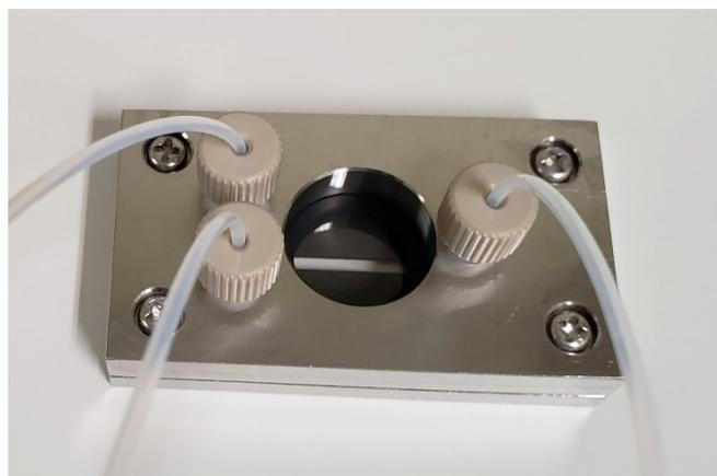
図 5-4. 交換反応に用いたステンレス製フローセル。
