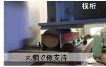
(c) 横桁端部支持状況
