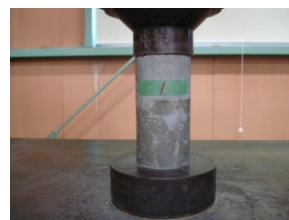
JIS A 1108 (φ50mm × 高さ100mm) に準じ、圧縮強度試験を実施
