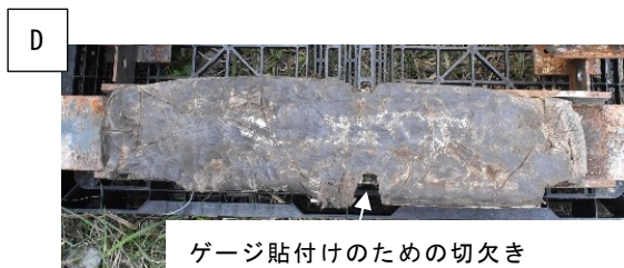
図 5.32 繰返し載荷試験後における CA モルタルの損傷調査状況
