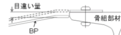
図 5.27 繰返し载荷試験（荷重振幅 150kN）における BP の目違い量の推移
