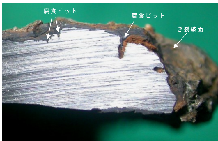
(d) 図 2.24 の A-A 断面のき裂破面近傍
