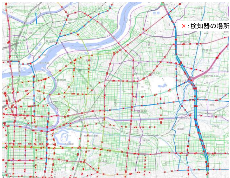
図 5.3 対象範囲と車両検知器の設置箇所
