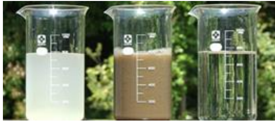
Fig.1- 5 MBR 処理前と後の水の外観(左：原水，中央：MBR 槽内水，右:処理水)
