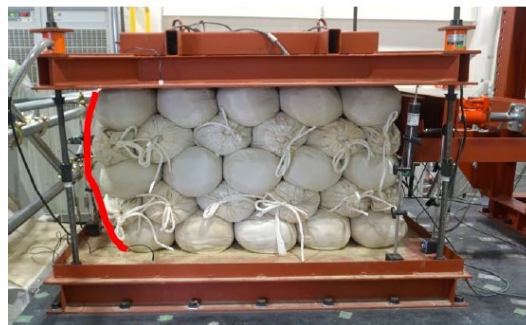
写真-6.4-3 加振前後の土のう構造体の状況（上図：加振前，下図：加振後）
