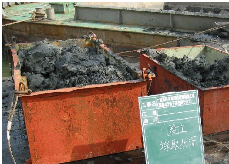
写真-3.4-2 護岸整備対象の木津川において採取した粘性土
