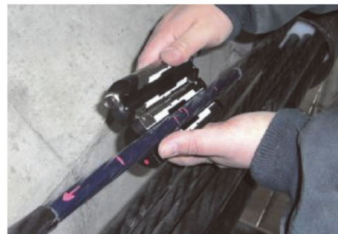
b) 外ケーブル張力を測定するセンサ
