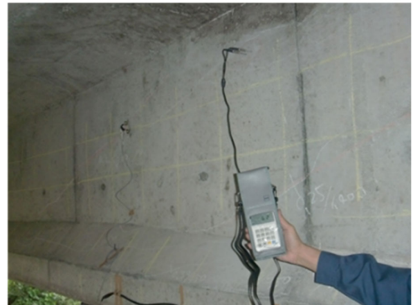
図 3.63 コンクリート内部の含水率測定状況
