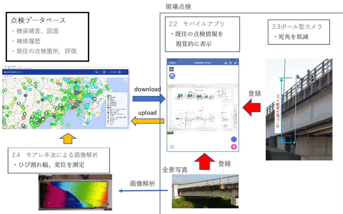
図 2.2 遠望目視点検を有効化する ICT ツールの概要
