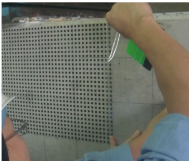
図 2.44 モアレ法による格子設置状況
