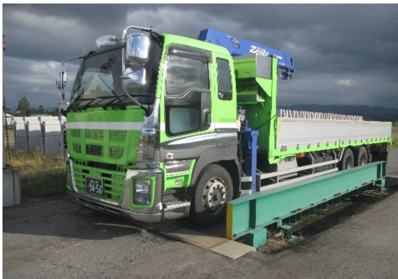
図 3.67 軸重測定状況
