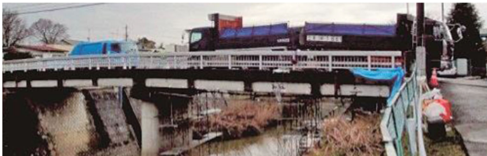
図1.34 車両による静的载荷試験状況 27)
