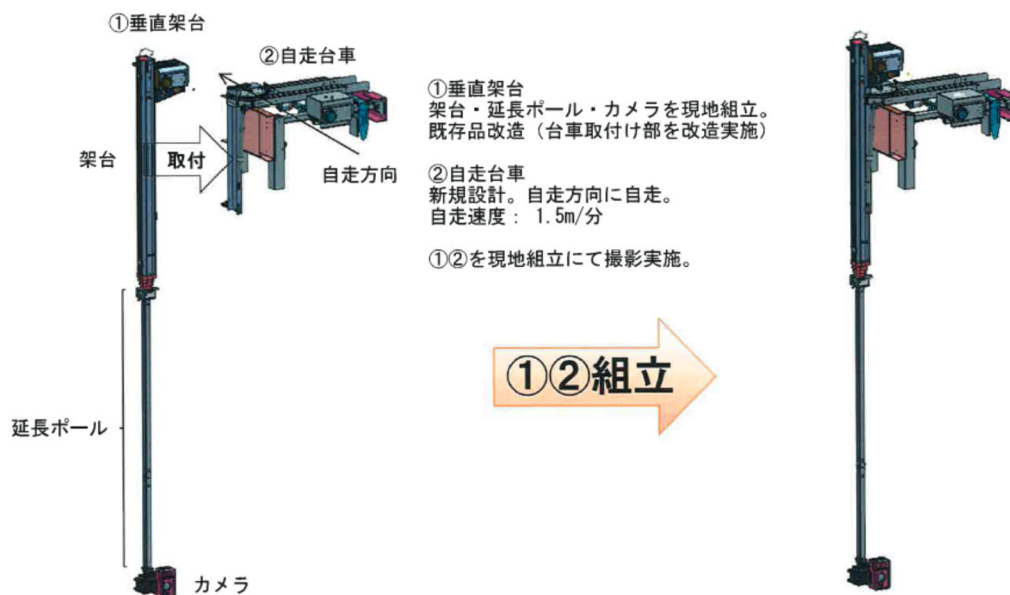
図 2.31 自走式ユニット: 自走台車と懸垂型カメラを組立 7)
