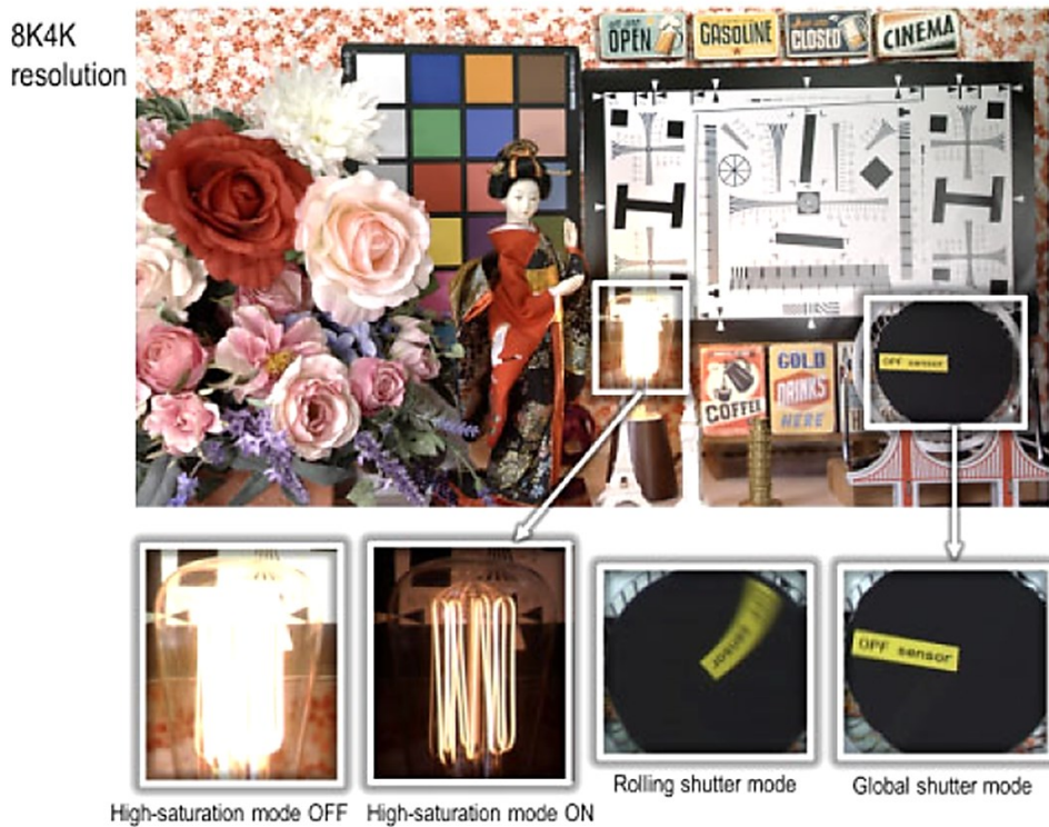
図2-21. 8K4K高解像度を実現する有機CMOSイメージセンサによる撮像
