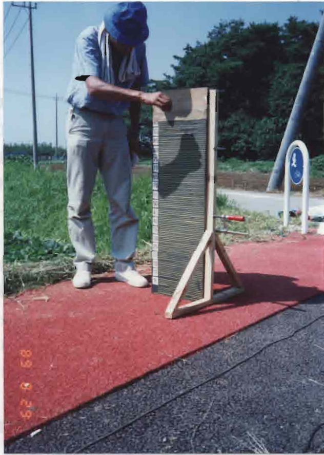
写真 2 - 9 ボール落下による反発係数試験
