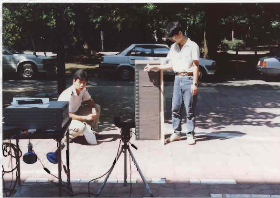
写真 2 - 3 ボールを用いた反発係数測定試験
