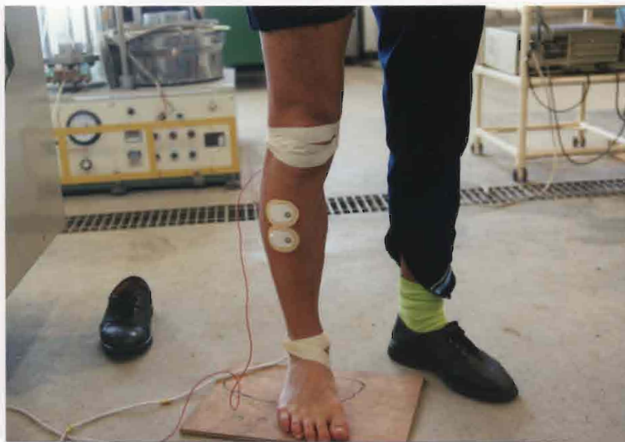
写真 2 - 8 加速度計の取り付け位置と筋電図測定状況
