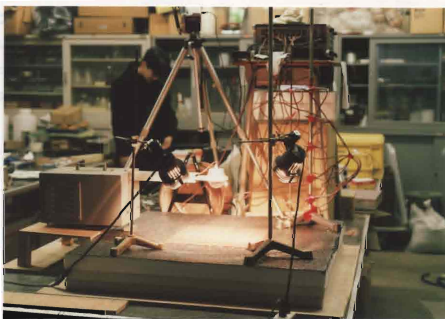
写真 4 - 4 舗装材料の放射エネルギー測定状況
