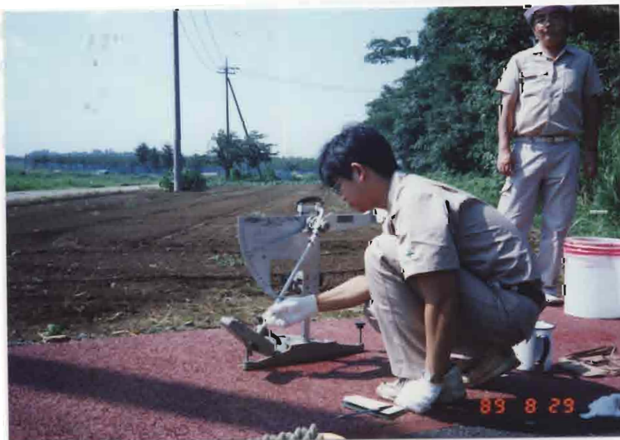
写真 2 - 10 B P S T を用いたすべり抵抗測定試験
