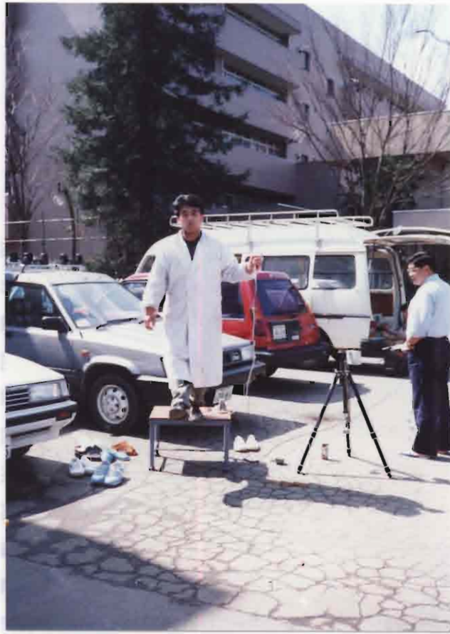
写真 2 - 2 人体による衝撃試験
