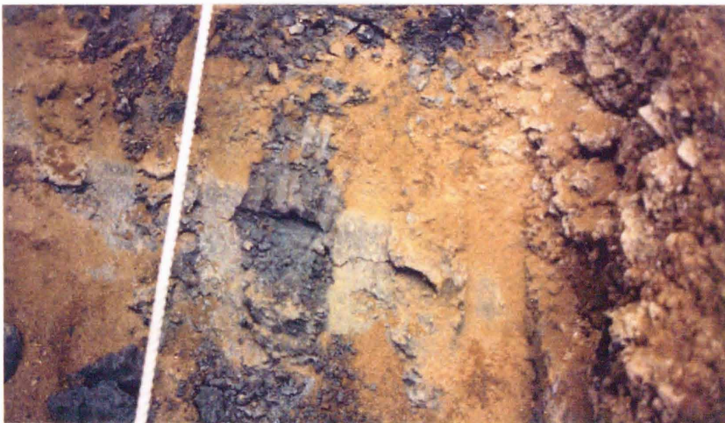
写真-2.3 試験斜面の すべり面を 形成した粘 土化層
