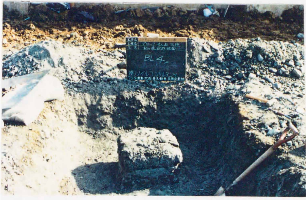
写真-5.5 礫岩の原位置せん断試験テストピット
