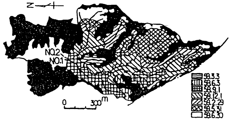
図-3.12 盛土の進捗状況
